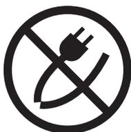
電源コードや電源プラグにキズや、ヒビなどが入ったものを使用していると火災などの原因となります。定期的に電源コードや電源プラグをコンセントから抜き、点検してください。
