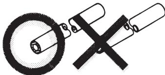
市販の塩化ビニール製ブレードホースを用い、漏れやエアの吸込みがないよう確実に接続してください。
