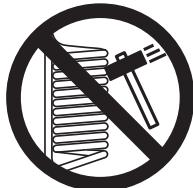
冷却コイルが凍結した場合はクーラーの電源を切り、水（液）槽から冷却コイルを取り出して自然解凍してください。
