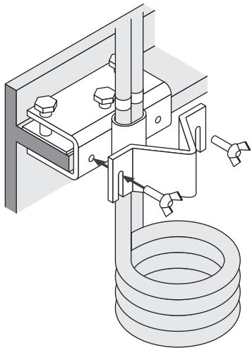
5. 冷却コイルをコイル固定部で挟み、蝶ボルトで固定する。
