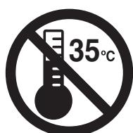
35°Cを超える液体に使用すると、コンプレッサーが過負荷になり、クーラーの寿命が低下する恐れがあります。35°Cを超える水（液）体を使用しないでください。
